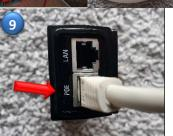
Verbindung Netzwerkkabel und POE-Adapter ( A Achten Sie bei der Verlegung des Netzwerkkabels, dass es weder eingequetscht wird, noch eine Knickstelle aufweist!)
